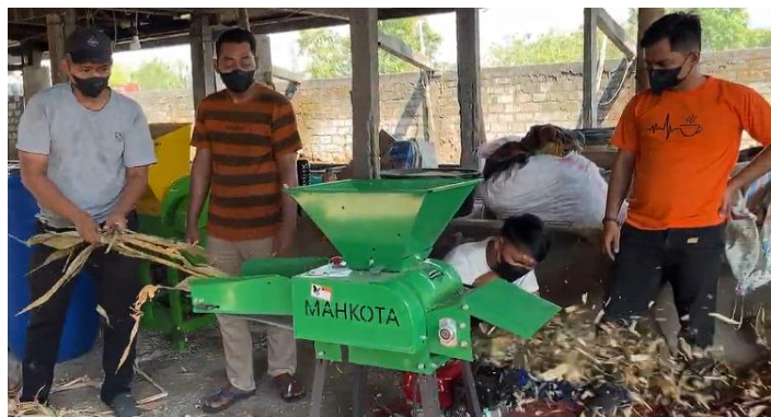
Gambar 2. Pelatihan dan penerapan mesin pencacah rumput
